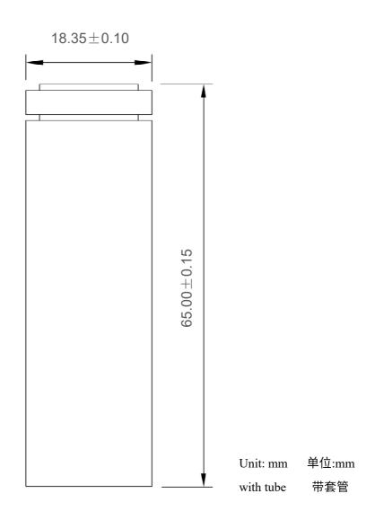
Fig. 1. Outline Dimensions of ICR18650/26V 图 1. ICR18650/26V 外形尺寸
